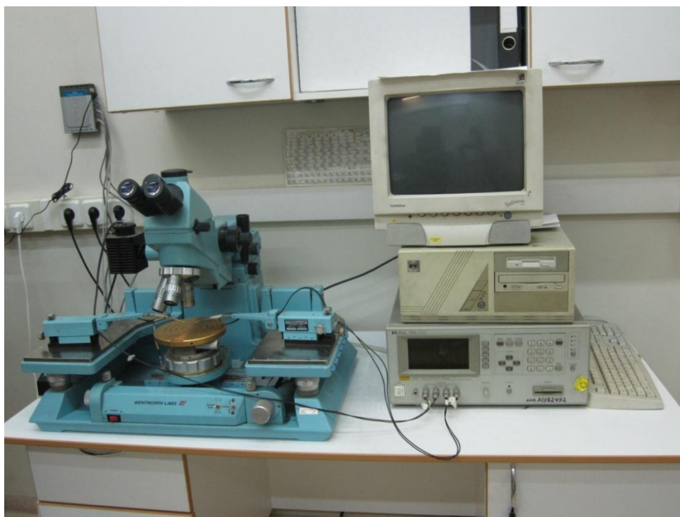
Рис. 39. Внешний вид измерительного стенда для снятия вольт-фарадных характеристик
