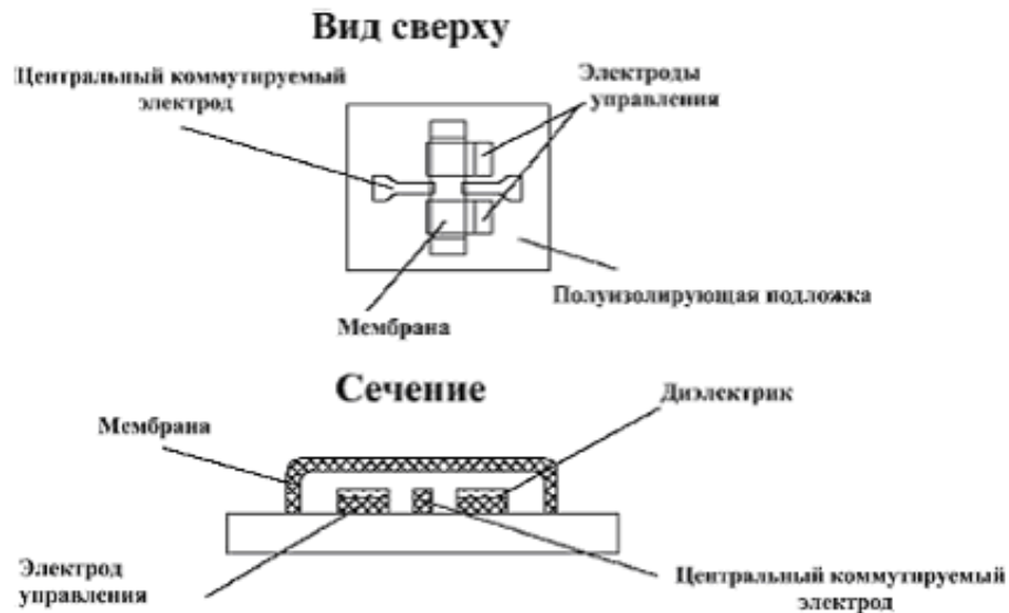
Рис. 7. Мембранный емкостной переключатель.
