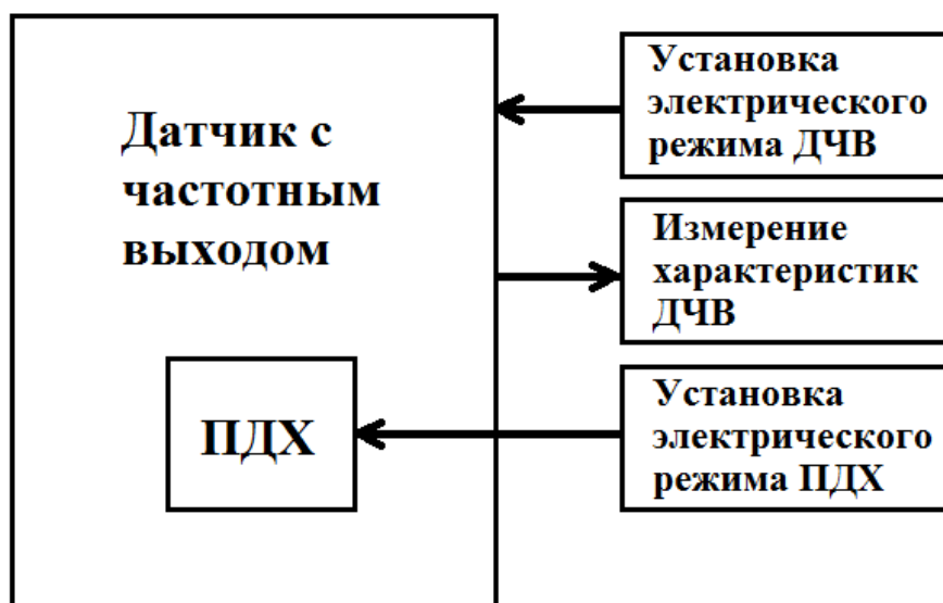
Рисунок 27 – Блок-схема для измерений характеристик выходного сигнала ДЧВ, использующих ПДХ в качестве чувствительного элемента
