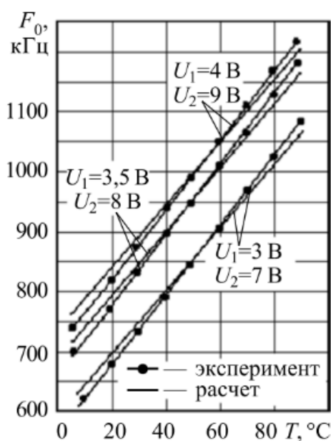
Рисунок 11 – Теоретические и экспериментальные зависимости выходной частоты автогенераторного датчика с частотным выходом от температуры
