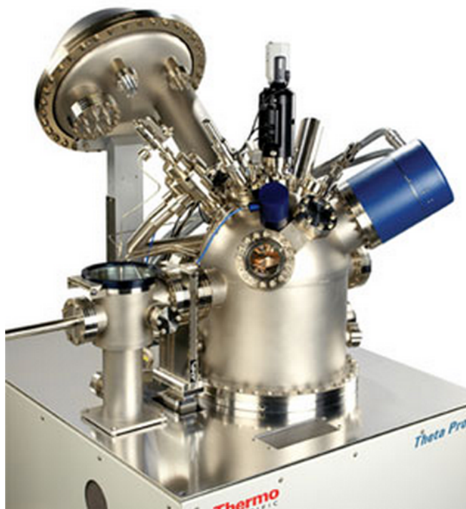
Рисунок 1.6 — Вид установки Theta Probe для РФЭС УР.
