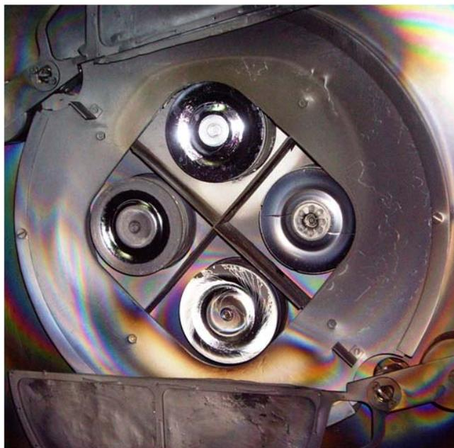
Рисунок 2.29 - Блок магнетронов установки Оратория 22
