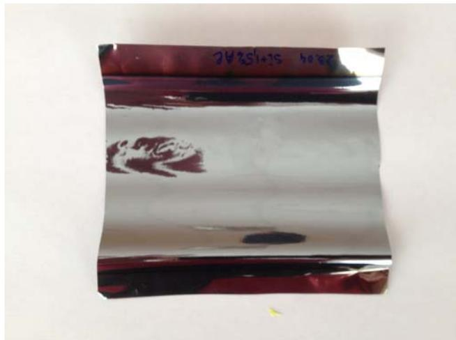
Рисунок 2.31 – Экспериментальный образец тонкопленочного электрода состава Si-O-Al
