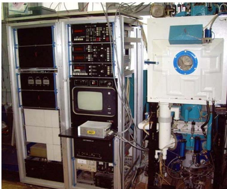
Рисунок 2.28 - Установка магнетронного напыления Орастория 22. Оборудование ЦКП «Диагностика микро- и наноструктур»
