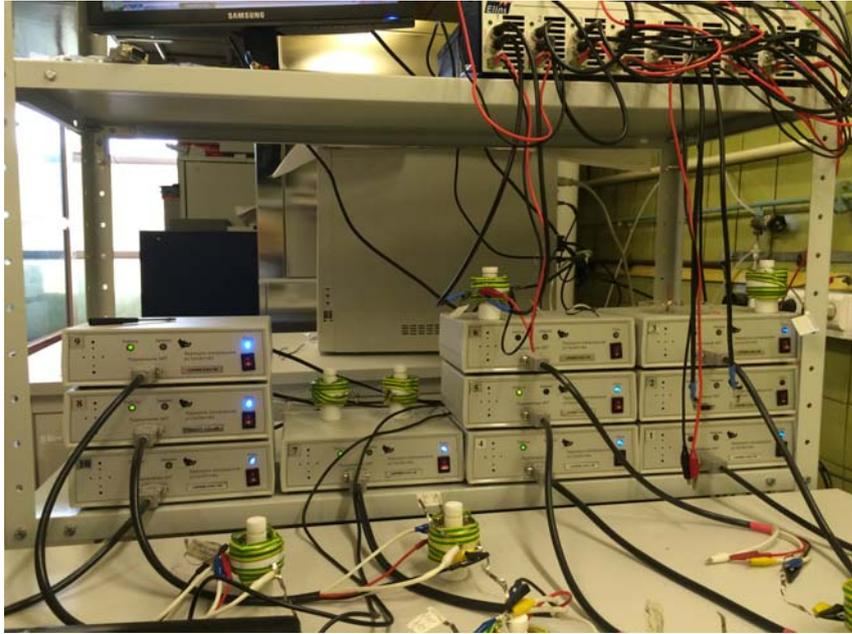
Рисунок 3.1 - Автоматизированный зарядно-разрядный измерительно-вычислительный комплекс АЗРИВК10-0,05А-5В с подключенными аккумуляторными ячейками
