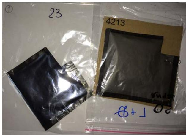
Рисунок 4.3 - Положительный и отрицательный электроды, использовавшиеся при изготовлении макета литий-ионного аккумулятора с твердым электролитом LiPON
