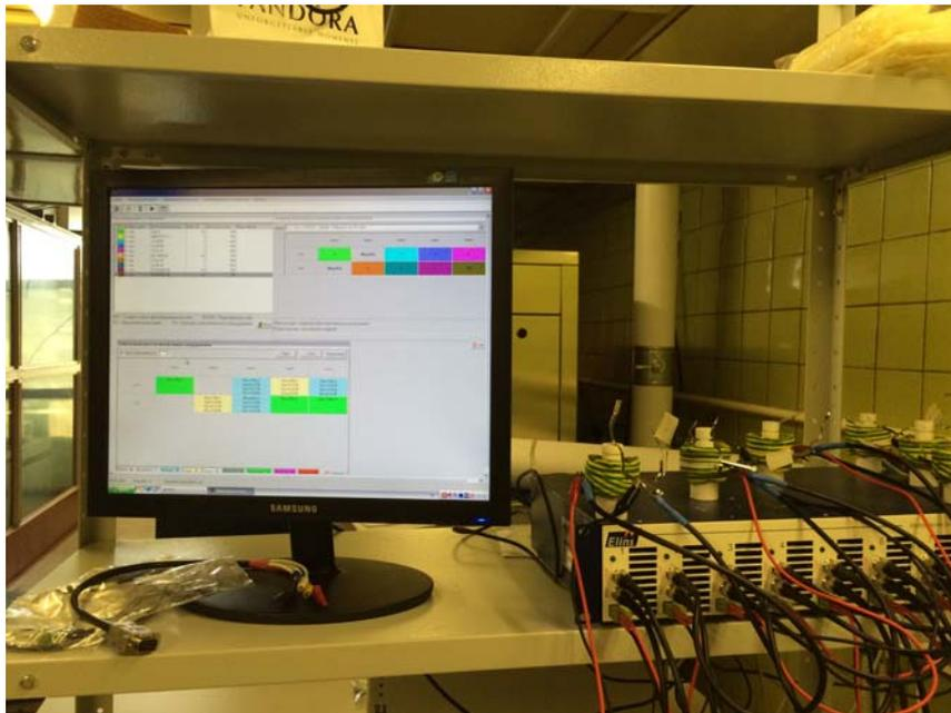
Рисунок 3.2 - Многоканальный потенциостат P-20X8 с подключенными аккумуляторными ячейками
